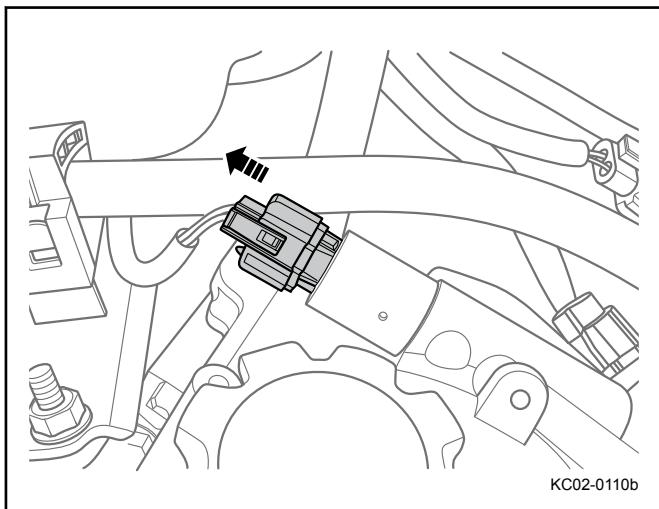
4. 拆卸进气 VVT 电磁阀螺栓。
