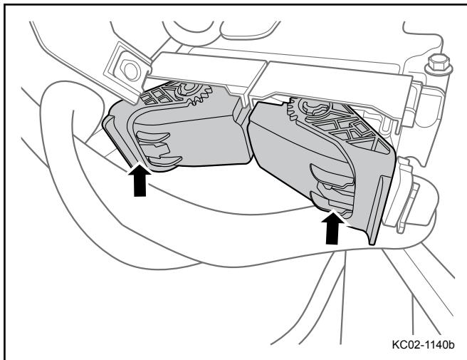
3. 断开发动机控制模块线束连接器。
