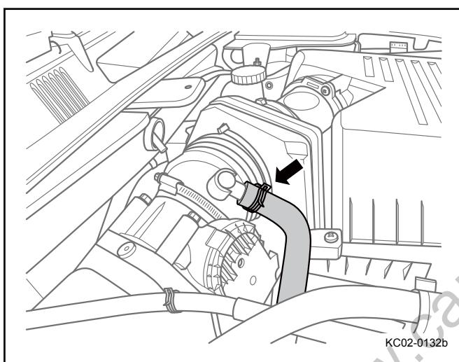
5. 拆卸曲轴箱通风管固定卡箍，拆卸曲轴箱通风管。
