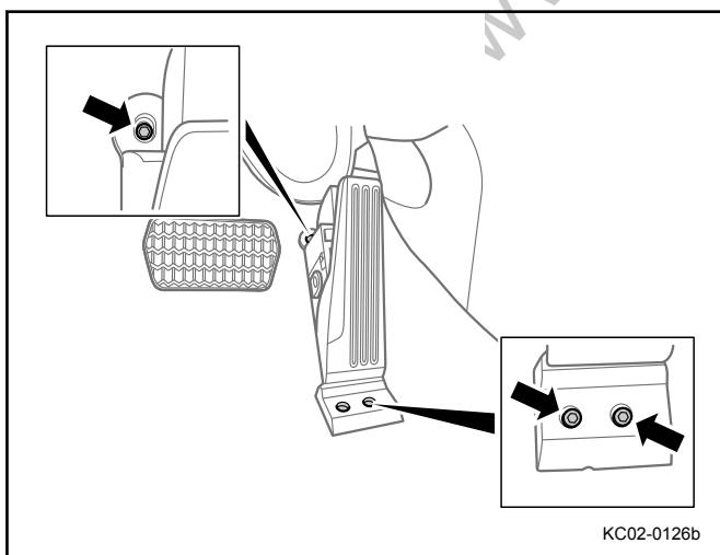
2. 安装油门踏板总成并紧固固定螺母。
