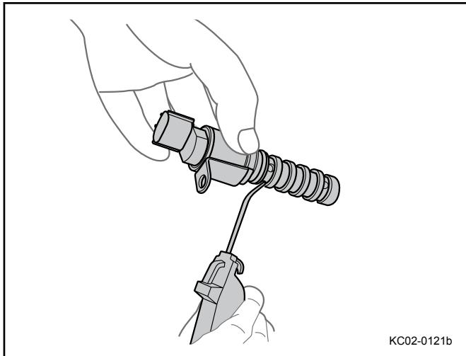
2. 用气枪对 VVT 电磁阀油孔及滤网进行清洁，把残留的清洗剂清洁干净。
