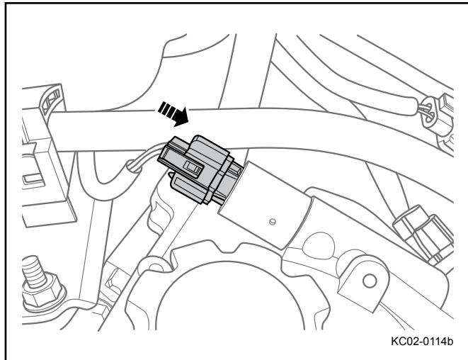
3. 连接进气 VVT 电磁阀线束连接器。
