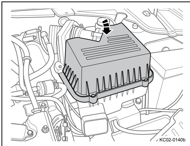
5. 安装发动机空滤总成并紧固固定螺母。
