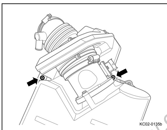
8. 拆卸进气软管固定螺钉。
