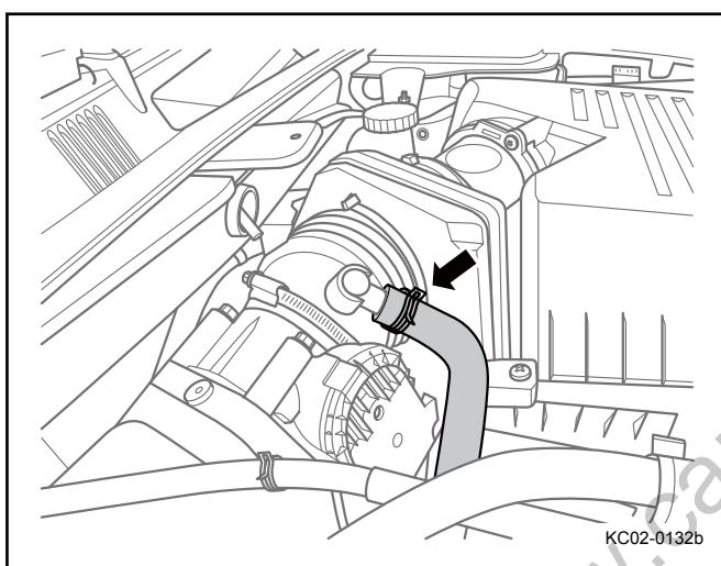
6. 安装曲轴箱通风管并安装曲轴箱通风管卡箍。
