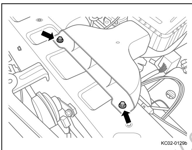
9. 安装并紧固空气滤清器进气管固定螺栓。
