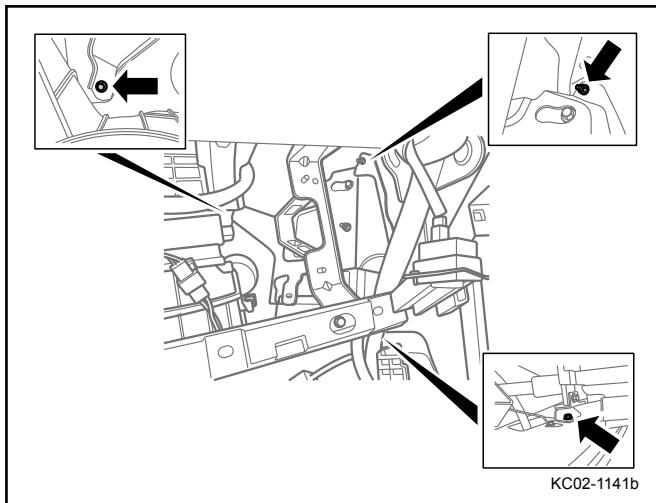
3. 安装并紧固发动机控制模块支架螺栓、螺母。
