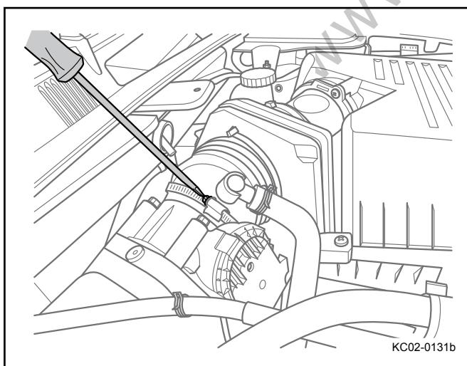
7. 使用专用工具安装并紧固发动机进气软管固定卡箍。
