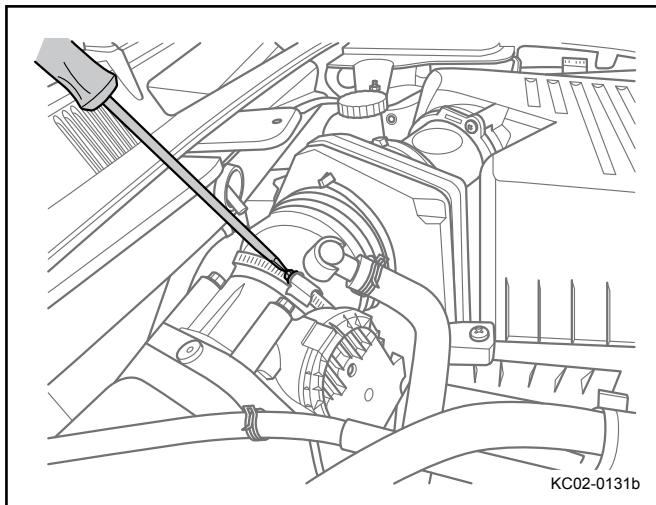
4. 拆卸发动机进气软管固定卡箍。
