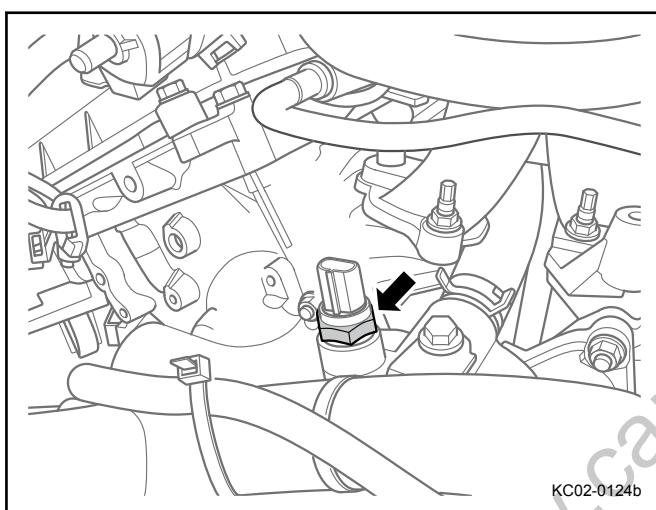
4. 拆卸发动机冷却液温度传感器。
