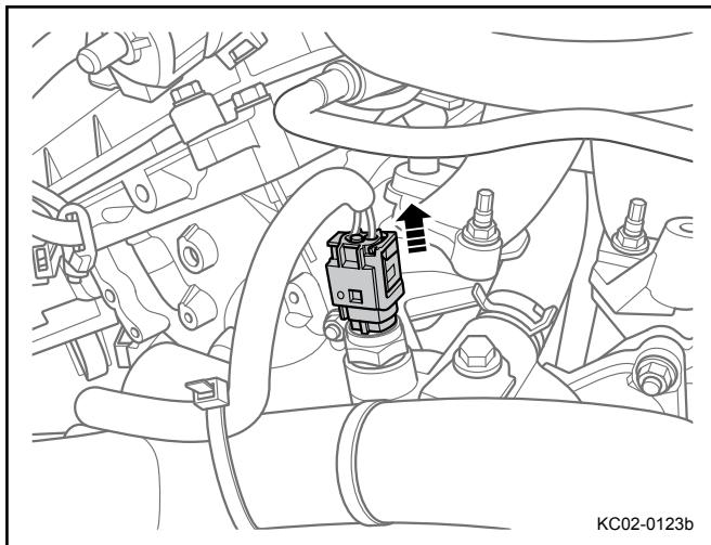
3. 断开发动机冷却液温度传感器线束连接器。
