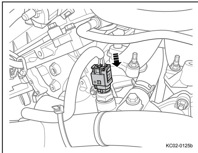
3. 连接发动机冷却液温度传感器线束连接器。
