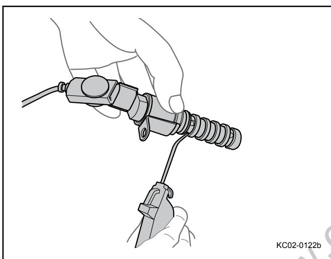
3. 不停地给 VVT 电磁阀通电、断电，让其在打开与关闭的状态下工作，然后再用气枪对其进行清洁，重复 2-3 次。
