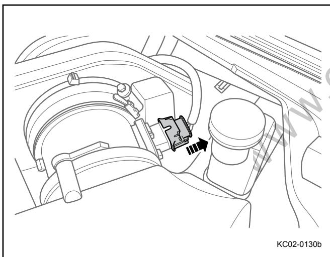
3. 断开空气流量计线束连接器。
