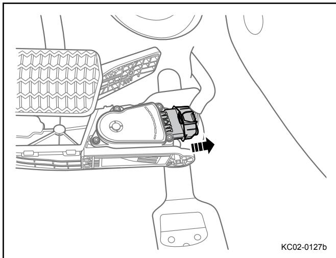
4. 断开油门踏板总成线束连接器。
