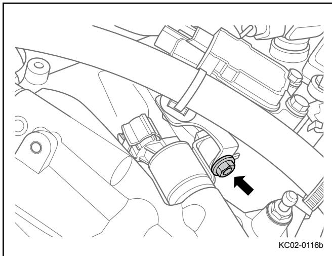
4. 拆卸发动机线束支架固定螺母。
