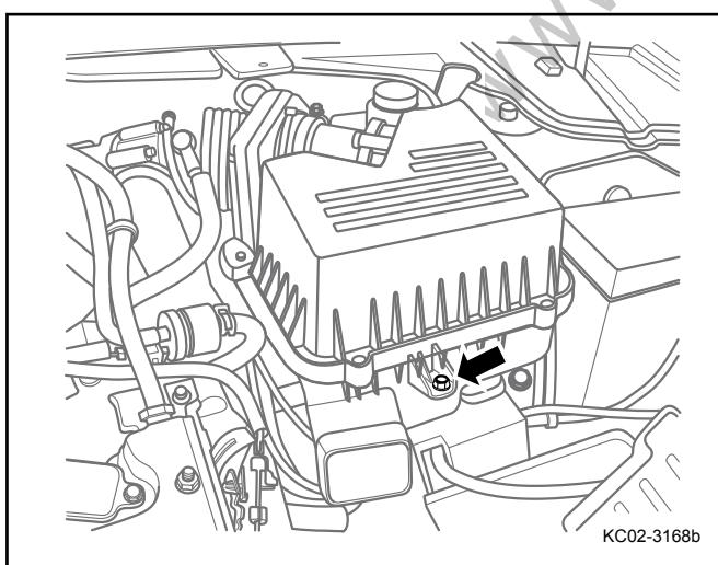
6. 拆卸空气滤清器固定螺母并取出发动机空滤总成。
